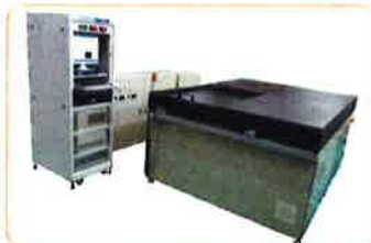
▲(上)太陽電池モジュールテストは、 結晶系、薄膜系、化合物系と、全てに対応。 (下)マイクロクラック検査装置は、太陽 電池セル、モジュール生産工程で課題とな っているマイクロクラックを可視化し、歩 留まり向上と長期信頼性を確保する
